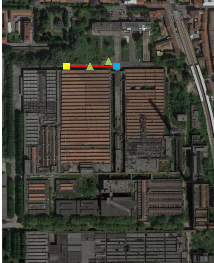
Figura 2 – Ubicazione delle stesa sismica (linea rossa); con il quadrato blu è indicata la posizione di energizzazione; con il quadrato giallo la posizione del geofono ricevitore; con il triangolo verde la posizione dell'acquisizione HVSR
